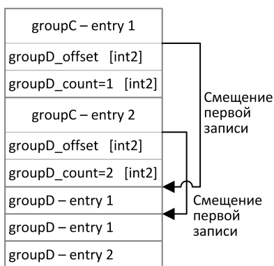
Рисунок 5. Схема двухуровневого вложения компонентов
